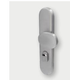
AI 69 E UND A70 E + 69 E Edelstahl (E) Kombi-Sicherheitsgarnitur: außen Langschild, innen Ro- sette, ES1 geprüft, RC 2 geeignet. Kernziehschutz, außen gehärtete Stahlunterkonstruktion. G 238
