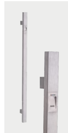
AI 218/ 219/ 220/221 E Stoßgriff mit Fingerkey für Motorschloss. A218/219 E Länge: 1000mm. A 220/221 E Länge: 1500 mm. Einbau vorne oder hinten verdeckt.
